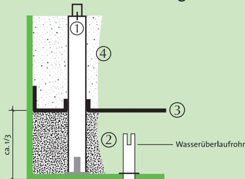
1. Die Wasserstandsanzeiger (falls gewünscht) müssen vor dem Einbringen der Dränageschicht in die Gefäße gestellt werden.
