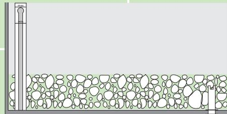
Etwa 1/3 der Gefäßhöhe mit Domino Hydrokorn auffüllen, jedoch mindestens so hoch, dass das Wasserüberlaufrohr 5 cm überdeckt wird.
